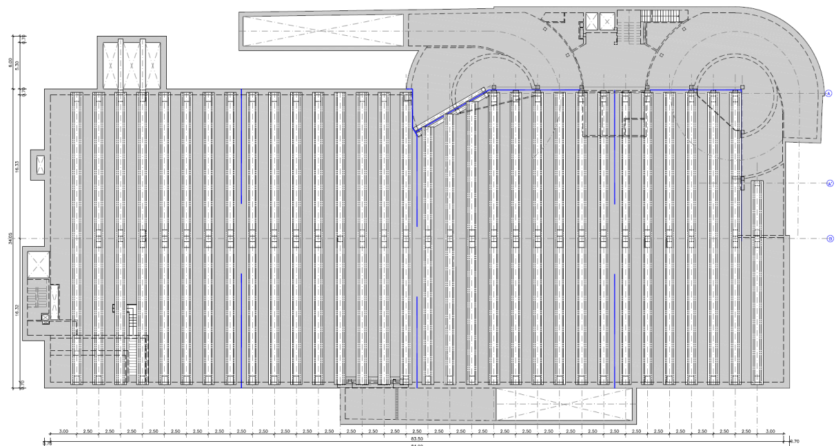
Figura 1. Distribución de juntas en Aparcamiento Santa Ana (estado actual)
